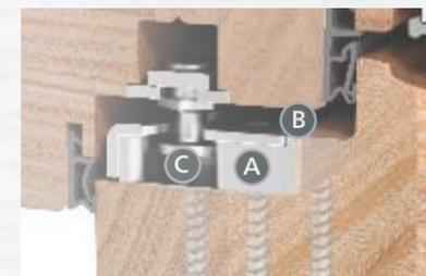
Sicherheitsschließteile mit Spezialschrauben verankert (A) in Verbindung mit 4mm Falzlufte (B) und SafeGuard-Pilzkopfverriegelung (C) machen es Einbrechern schwer, den Flügel aufzuhebeln.
