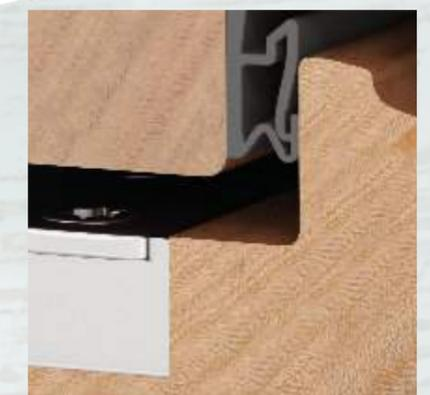
Die auf 4 mm reduzierte Falzluft\* erfordert höchste Präzision in der Herstellung der Elemente und lässt dem Täter nur wenig Spielraum. \*Ab 78 mm Profil-Bautiefe.
